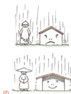
Le forget débordant, une protection simple contre le soleil d'été (1) et la pluie (2)
